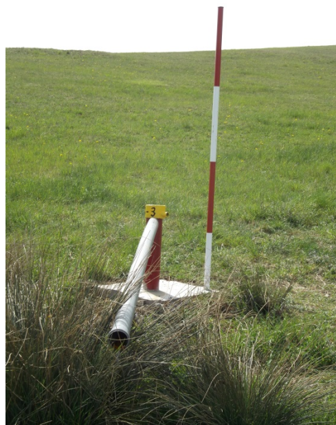
Provizórne odvedenie vody z vrtu s napätou hladinou
